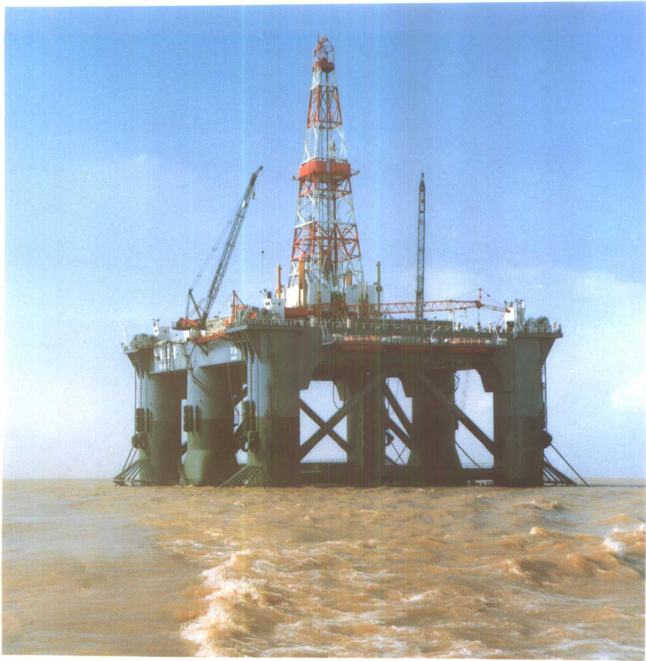
上海船厂建造的半潜式海上石油钻井平台在大陆架海域作业。
