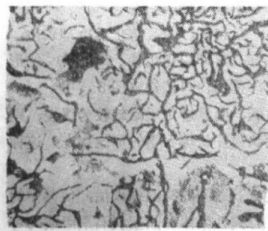
丙——灰口铸铁（ \text{HNO}_3 酒精溶液侵蚀， \times 500 ） 呈玫瑰花状分布的石墨碳，其大小为6*~7*，基体为纯铁体与少量细珠光体（淡灰色者）。
