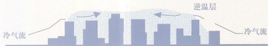
静风晴天条件下傍晚城市屋顶层形成的 图1-8 静风晴天条件下傍晚城市屋顶层形成的
