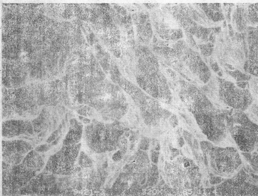
图7 1*样裂纹延伸撕裂部分
