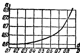
圖 7 隨膜板孔直徑與管道直徑的比值而變化的流速損失係數線圖
