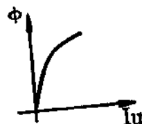
图3 励磁电流和磁通关系
