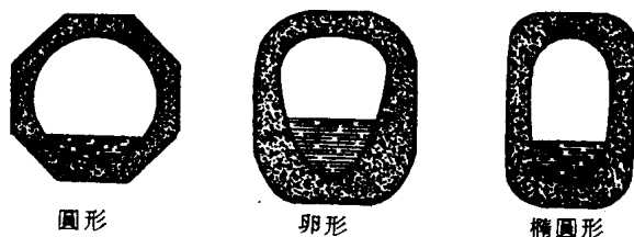
圖1 截流管的三種橫断面
