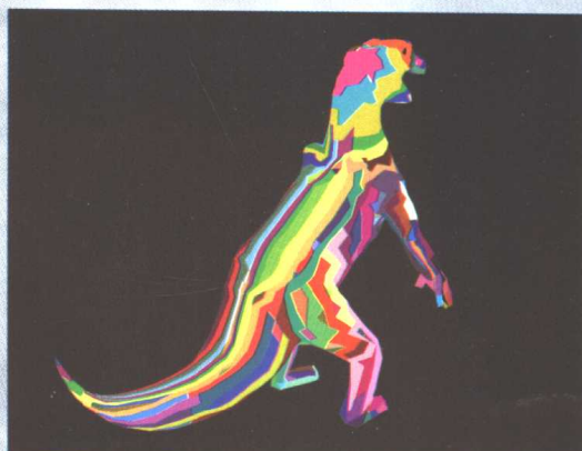
彩图5 本图显示的是三角形条带：(A)为鲨鱼的；(B)为龙的。每种颜色都代表了一个新的条带。鲨鱼模型的条带上平均顶点数目为20；龙模型则有243个条带，平均顶点数目为27个
