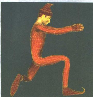
彩图7 带有指定权重输出的网格(A)用来自动生成新的权重值(B),然后在关节处使用更小的骨节进行增强(C)。几乎完全消除了基本蒙皮算法中缩小与伸展的缺陷
