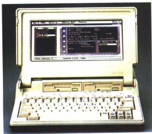
照片 10 带有液晶显示器的笔记本电脑。显示器是一种较新的超扭曲类型,而且是从背后照明的。(Tandy Corporation/Radio Shack 提供)
