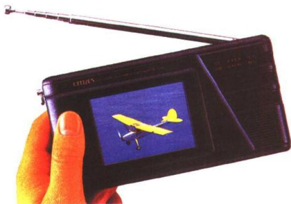
照片 12 带有液晶显示器的袖珍彩色电视机。这个显示器使用了主动矩阵技术。(Citizen Watch 提供)
