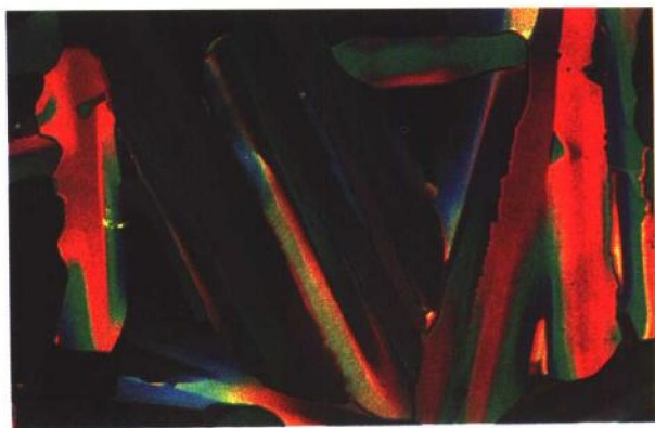
照片 5 层状 B 相液晶。液晶样品置于正交起偏器之间。 (J. Goodby 提供)
