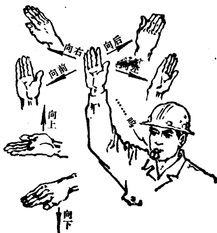
图1-17 指挥天车吊运方向的手势
