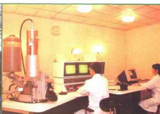
使用扫描电镜进行金属形貌观察
