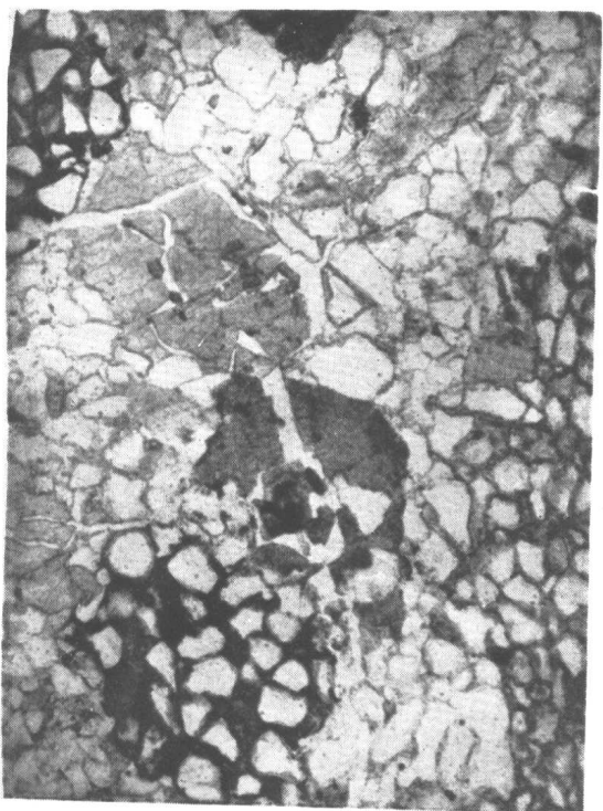
圖版 IV-1 准繭狀磷塊岩，白色粒為石英碎屑等被膠磷礦薄層環繞（灰黑色），近中心，白色板狀礦物為石膏風 161 風台 X120
