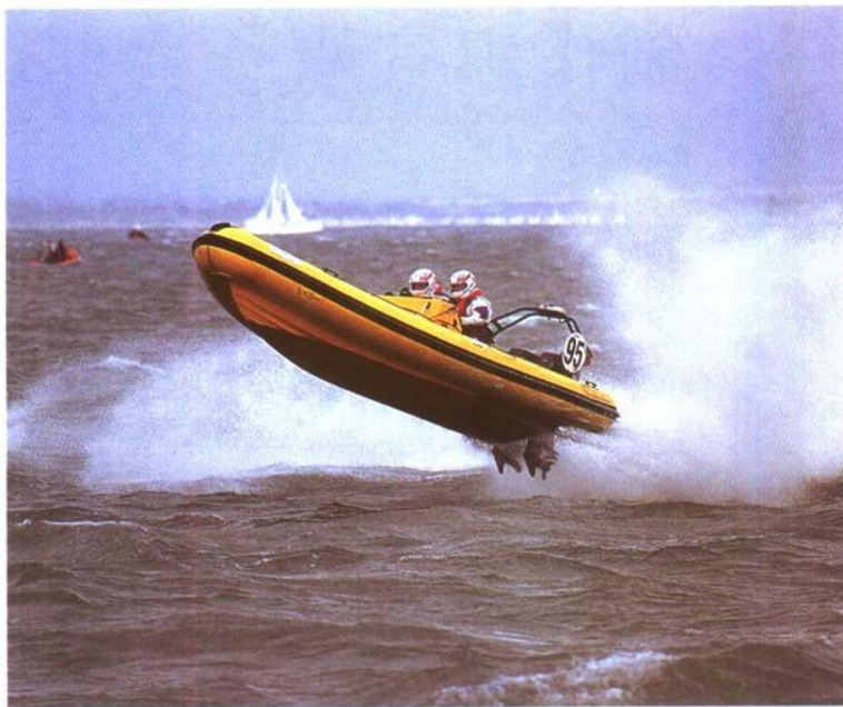
■ 快艇从被称为螺旋桨的旋转叶片中获得动力。螺旋桨向后推水，产生的反作用力推动快艇前进。
