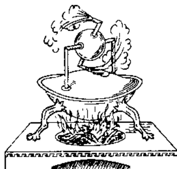
人類所發明的第一具“反動引擎”，赫洛的蒸汽噴壺，蒸汽由兩管中噴出，使得圓球轉動。
