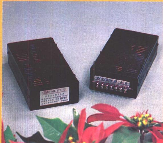
ML 1731、ML 1731A 开关直流稳压电源是北京计算机配件四厂综合国外各种开关电源电路，吸取各国产品的精华自行设计的产品，具有线路简单，制造、调试方便的特点。该电源效率高、安全可靠、波纹系数小、抗干扰能力强，与国外同类产品比较，输出电压、稳定度、纹波电压、可靠性等主要技术指标均高于国外产品水平。
