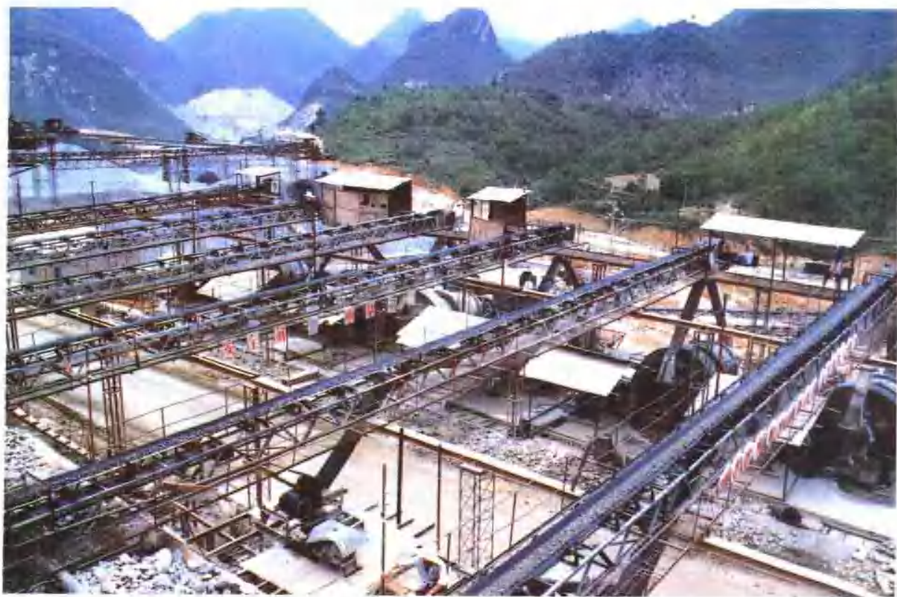
岩滩水电站人工砂石加工场，1985年建成投产，月产碎石10万立方米，砂4万立方米
