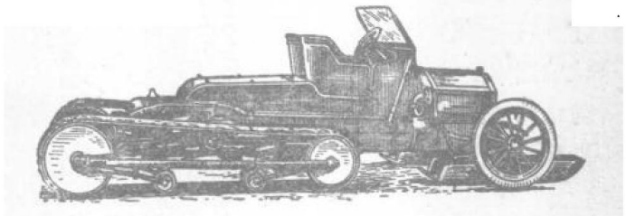
图 3 俄罗斯-波罗的海工厂的半履帶式汽車（“自动撬”）
