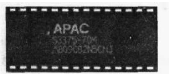
图 1-3 S3375 显卡上的 EPROM 芯片
