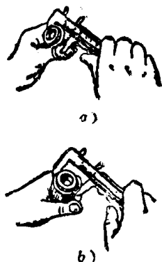
图11 测量外径尺寸的正确和错误的方法
