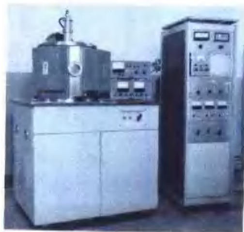
JCK-500型磁控溅射 台四靶、直流射频二用、 自动调压新型油扩散泵 系列(优于 1 \times 10^{-8} 托)
