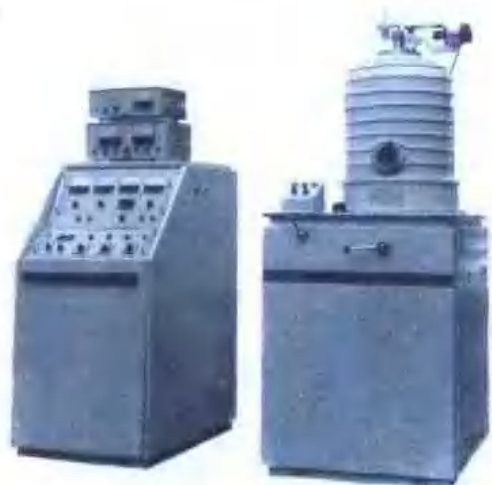
DMP-450型真空镀膜 机e型枪(8千瓦)， 自动复位、显形夹具
