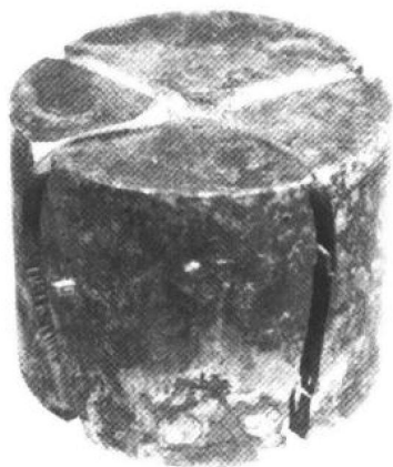
照片 2-6 T12 钢短圆柱试样的 四瓣全纵劈淬裂的形态, 0.5\times 热处理: 820^{\circ}\text{C} \pm 10^{\circ}\text{C} 加热, 水 冷至室温
