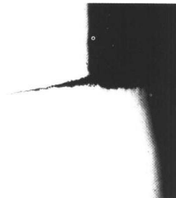
照片 4-3d 4-3a 所示淬裂的螺栓,由头杆截面过渡处的尖角上产生的横裂(纵裂性质的)在纵剖面上的形态,20×
