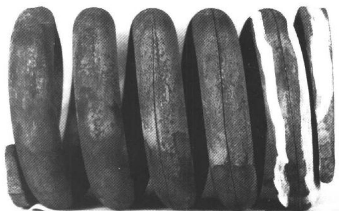
照片 4-6a 60Si2Mn 螺旋弹簧(φ30mm)上,沿弹簧外径螺旋线形成扩展的淬火裂纹(纵裂),0.5× 热处理:870℃ ± 10℃ 加热后,40℃ ~ 80℃ 热水冷却,480℃ ± 10℃ 回火 腐蚀剂:50%盐酸水溶液热浸蚀
