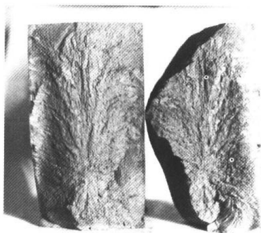
照片 2-9 T12 钢长圆柱试样( \phi 100 \times 185\text{mm} )的纵劈开裂及其断口宏观形貌 热处理: 820^{\circ}\text{C} \pm 10^{\circ}\text{C} 加热, 水冷至室温
