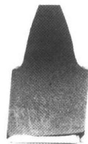
照片 4-12b ZG42CrMo 齿轮轮齿淬硬层的宏观分布(轮齿沿齿高基本淬透),1.2 \times
