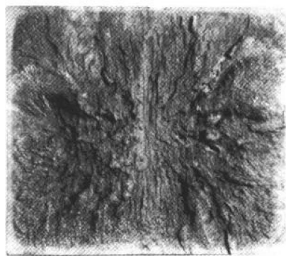
照片 2-5b T12 钢短圆柱试样纵劈的宏观断口形貌:中心辐射型花样,0.5×
