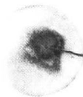
照片 4-11b 4-11a 所示纵裂的横截面形态及试棒中心区域的碳偏析(黑色区域), 1\times
