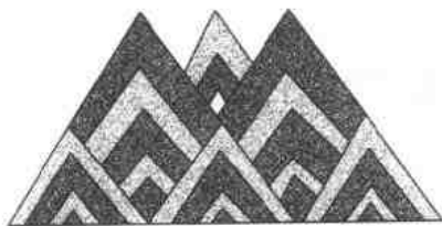
图 5 条形堆料断面图
