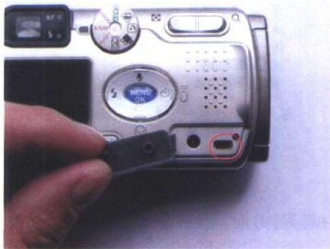
图 1.6 “三星 Digimax V4” 的 USB 接口
