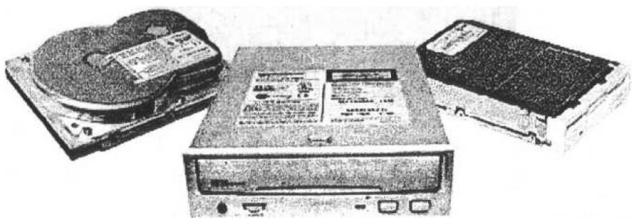
图 1.8 驱动器外观图（从左到右依次是硬盘、光驱和软驱）
