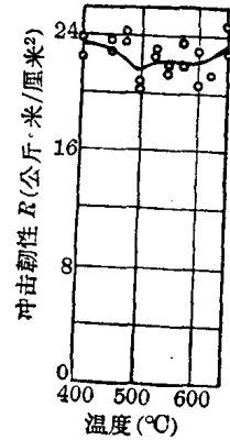
图 10 A 钢试样调质结果: 1000°C/2 小时/油冷 -750°C/2 小时/油冷,并在不同温度下回火 2 小时
