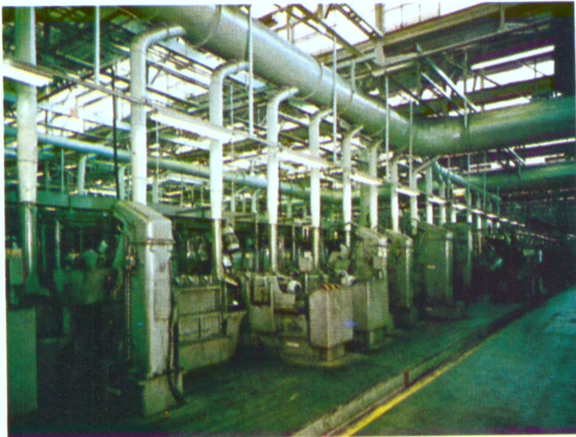
藉著自送聯製機械加工的汽缸體
