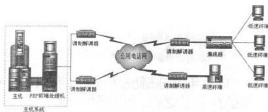
图 1-2 具有远程通信功能的多机系统
