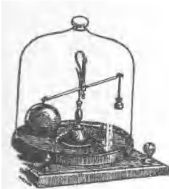
第 167 圖 空氣密度計證 實空氣的浮力
