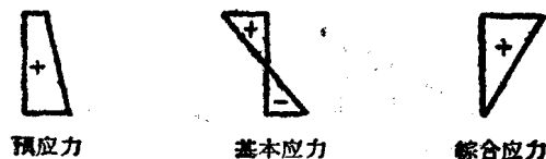
图 2 只产生压应力的預应力
