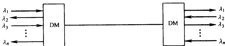
图 1-3 双向 WDM 光纤通信系统的组成
