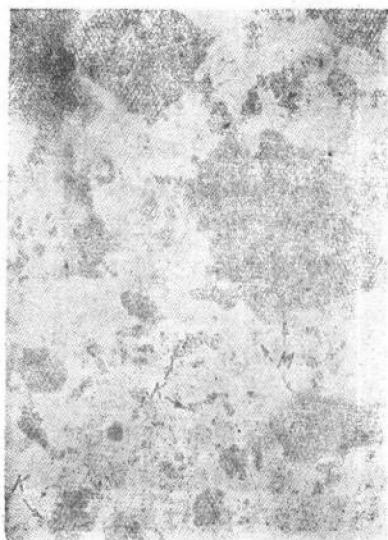
圖 6. 細鱗片狀的膨脹性蒙脫石 (M) 和方英石 (E)。 放大15,000倍
