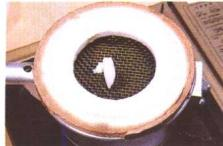
大会将银土烧熔，太小则造成温度不够，作品不够坚固的问题。开火后小炉上的铁网呈现稍暗桔红色为佳。
