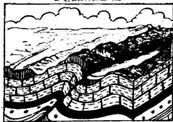
3 岩层受力继续加强发生断裂
