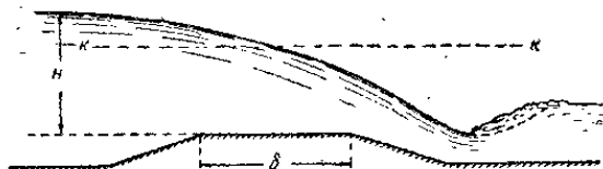
圖 4 堰頂水平的實用堰。
