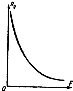
图 8-11 炭柱电阻与片间压力的关系曲线
