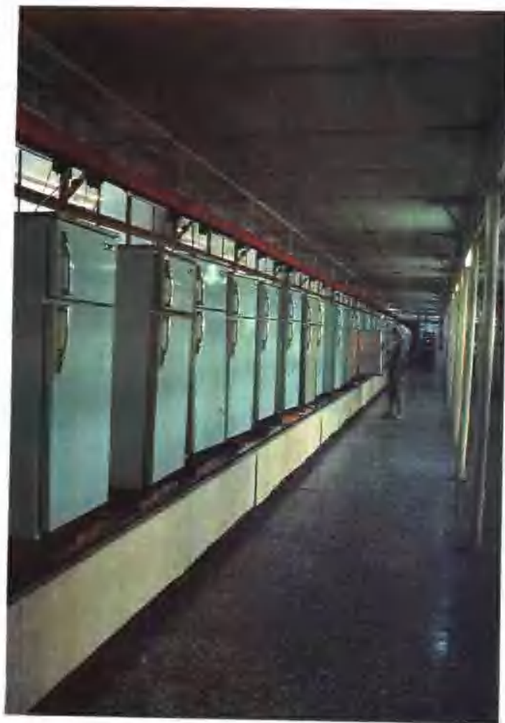
→ 北京电冰箱厂产品质量检测线
