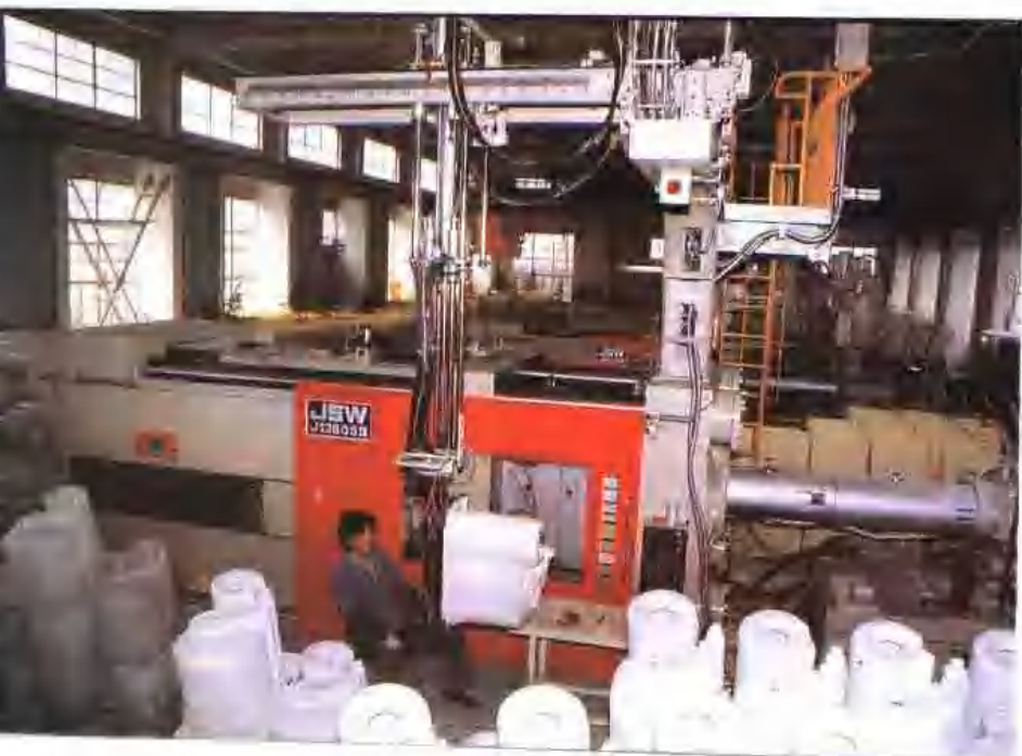
“白菊”喷淋双缸洗衣机塑料桶一次成型注塑机
