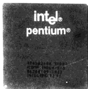
图 1.1 Intel Pentium 100 CPU 芯片
