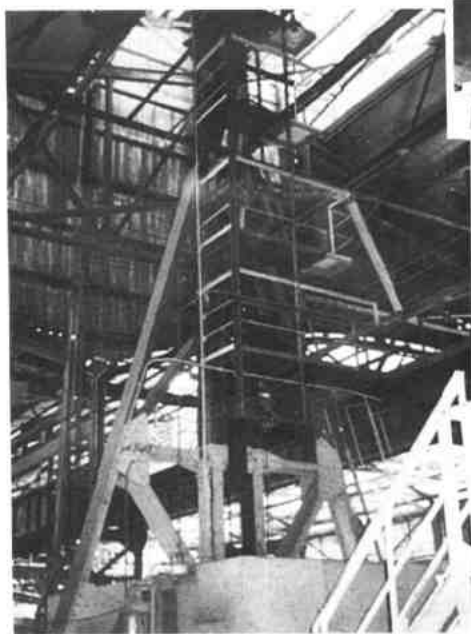
←㉑ 钢轨落锤试验装置——全景
