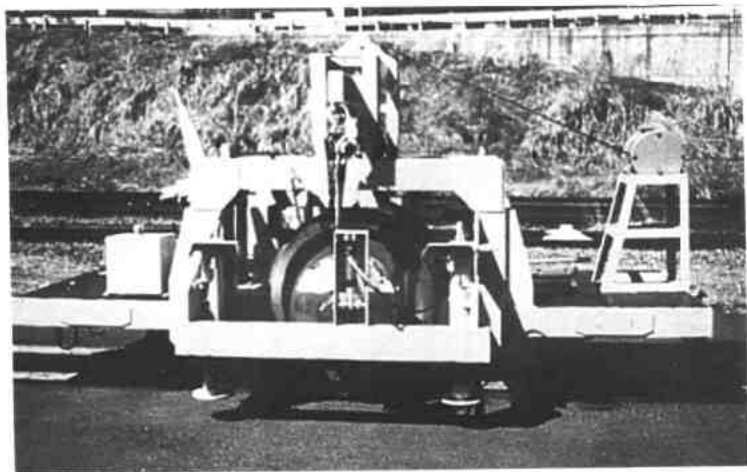
← ⑮ 移动式轮对落下试验装置
