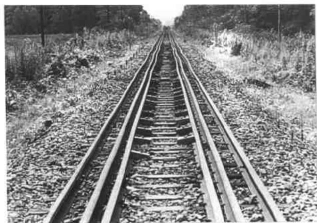
→ ② 狩胜试验线 — 设定的轨道变形
