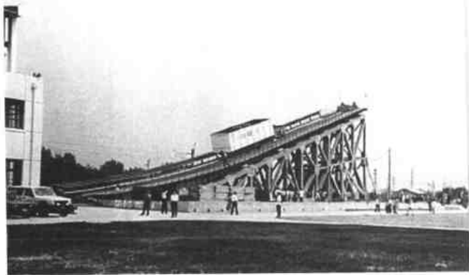
↓ ㉗ 中国的往返滚动轨道 加载系统全景模型
