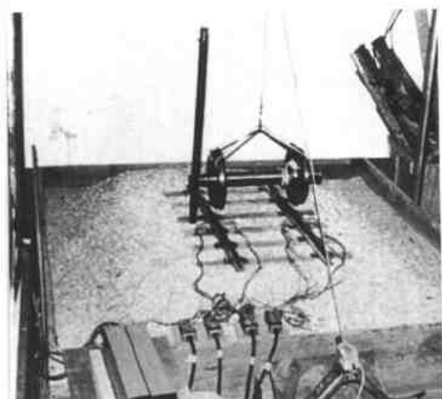
↑ ⑤ 轮对落下模型试验装置 — 土路基有碴轨道
