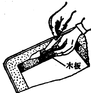
b) 砂型损坏较大的部位 可用木板辅助修型
