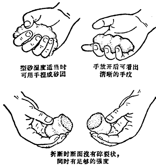
图 1-3 手捏法检验型砂
