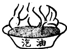
圖 1.1 汽油雖多，力量却小 （空氣祇和汽油表面接觸）
