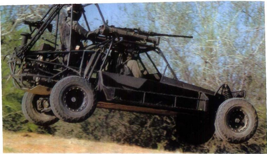
▲“海豹”小队使用的“沙漠巡逻车”。这种车装备2000马力发动机和超级冷却与排气系统，越野性能强，加满油可行驶500公里左右。
