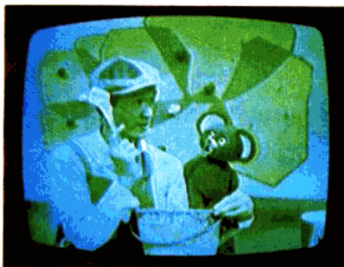
⑯ X 信號（紅信號）消失的圖像
