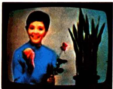
④ 有色緣失真的圖像（檸檬與手右端有色緣）
