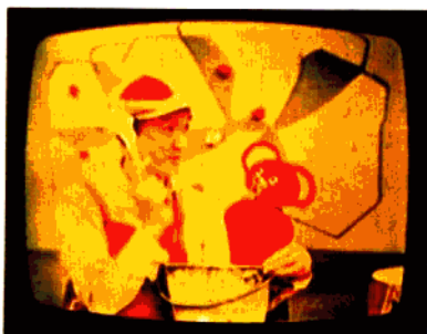
⑰ Z 信號（藍信號）消失的圖像
