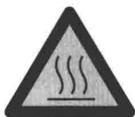
热表面警告标志 Hot Surface Warning Sign
