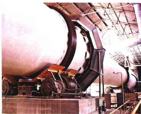
大石水泥廠一號窑，額定產量500噸/日，全部西德先進設備（1966）。
