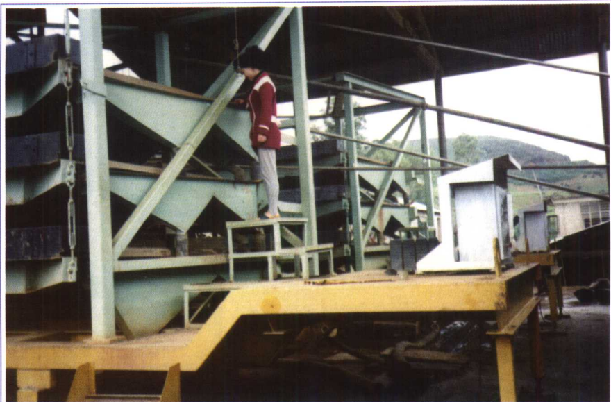
西盟佤族自治县锡矿浮选车间女工操作三层控式摇床选矿
