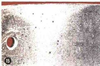
图 15 展示铜铅合金轴承中铅的腐蚀的情况。腐蚀(侵袭)损害的最大的来源大概是润滑油本身形成的氧化物。
