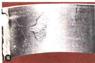
冲刷基本上是轴承表面被轴颈与轴承间的油流机械冲刷掉的现象。油中空气泡的形成与崩溃能够导致极高的局部压力,由“气蚀”作用造成轴承表面局部疲劳和麻点。如图 16。
