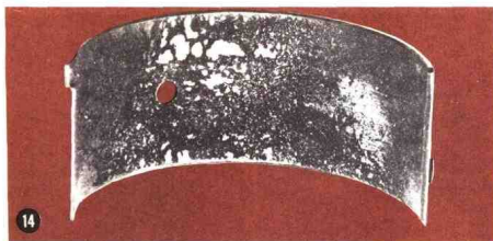
图 15 展示铜铅合金轴承中铅的腐蚀的情况。腐蚀(侵袭)损害的最大的来源大概是润滑油本身形成的氧化物。
