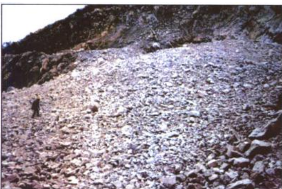
4-8 爆出的过渡料（最大粒径不超过30cm）堆积状态
