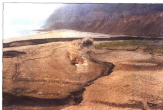
1-3-2 大江围堰爆破拆除塑料导爆管接力起爆网络试验：复式网络
