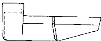
图1-10 压白道后的刀坯
