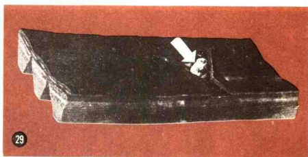
绑带中的洞和泡 在三角皮带之间积聚脏物和外来物质造成如图 29 所示的损伤。
