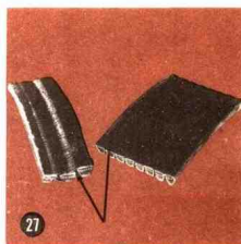
绑带上部擦伤或损伤 图 27 中的损伤是机器上障碍物干扰皮带的正常工作造成的。
