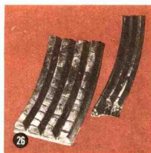
皮带的底部开裂 图 26 中的皮带是由于在太小的皮带轮上转动、打滑引起热的积累,使内层逐渐硬化而开裂,或者是由于使用了一个长时期而产生的开裂。
