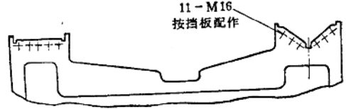
图25-1-29 床身端面安装挡板的螺钉孔示意图
